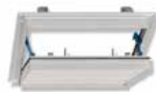
TRAPPE COUPE FEU PLAFOND 60MN - 36MM 2 PLAQUES DE 18MM - CERTIFICAT EI 60 PV N° RS-20-054
