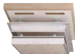
TRAPPE COUPE FEU PLAFOND 120MN - 50MM 2 PLAQUES DE 25MM - CERTIFICAT EI 120 PV N° RS-19-067
