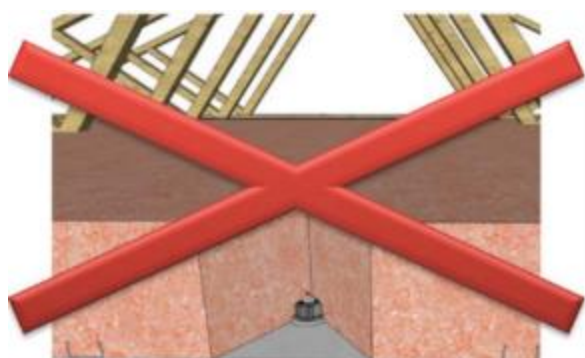
Figure 1 : Spot non protégé au contact de l'isolant INTERDIT
