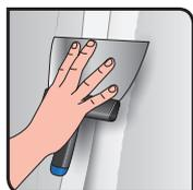
3. Recubrir la banda de junta de papel de cola con enlucido, junta y placa de yeso en dos pasadas (carga y acabado).
